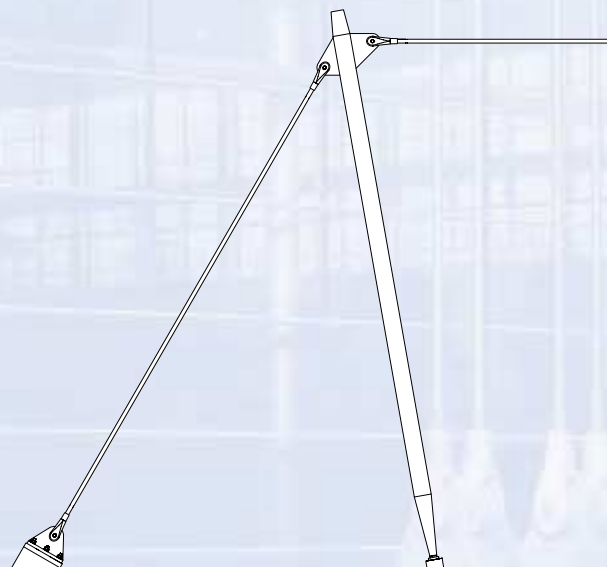
Atirantado de pilares
